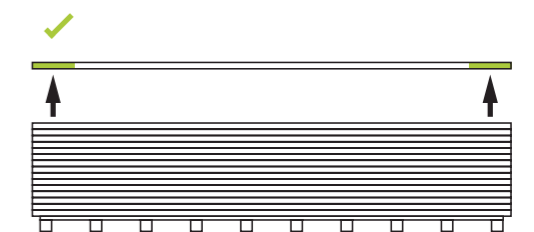
Heben Sie die Paneele an den Kanten mit jeweils 2 Personen an
